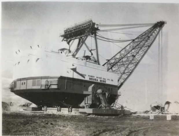
世界最大のDragline（石炭の被覆岩石を掘りとる機械）Marion 8900型 車量 6000トンbucket 容量 100m 3 、一掘りに約200トンの岩石を掘りとる。 (B) bucket (C) 乗用車 (E) 人物 - 江尻宏一郎氏
